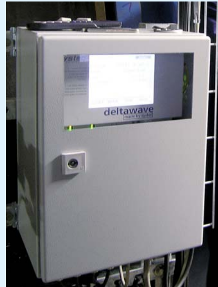
PRÄZISE ERGEBNISSE: Bild 4 deltawave-Auswertelektronik
