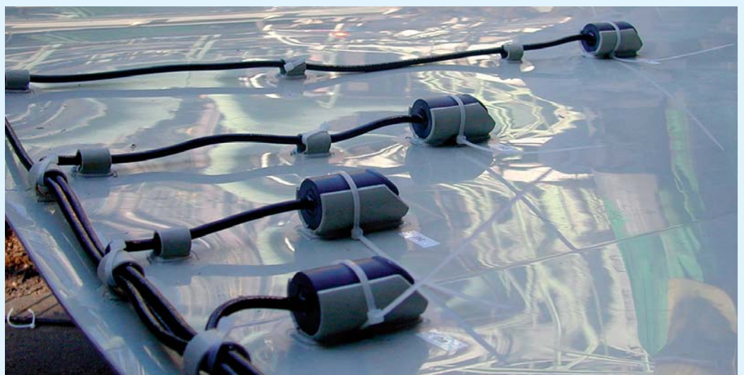
VORMONTIERTER SPANNRING: mit bereits befestigten Ultraschallwandlern
