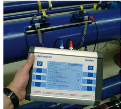
Das großzügige Display und die 8 Soft Keys sorgen für eine einfache intuitive Bedienung.
