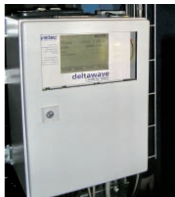
Das Elektronikgehäuse zum deltaxwave: Schutzart IP65 mit Touchscreen, hintergrundbeleuchtetem Grafikdisplay, 4 variabel bestückbaren Steckplätzen für max. 16 Messpfade
