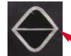
Herkömmliches Sondenprofil: Schweißnähte und Oberflächenbearbeitung an den kritischen Stirnflächen. Asymmetrien und Toleranzen in der Stirnbreite sind die Folge.
