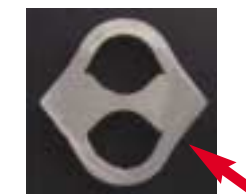
Sondenprofil der DF25: Schweißnähte in den unkritischen Kehren, keine Maßänderung an den Stirnflächen
