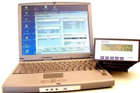
Insbesondere errechnet der flowcom die Mediumsdichten aus umfangreichen Tabellen und hat für Erdgas die GERG88-Funktionsgleichung hinterlegt.
