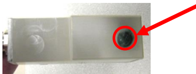
Abbildung 11: Wandler mit einem ca. erdnussgroßen Tropfen Koppelgel
