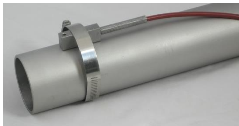
Abbildung 22: Pt100 auf Rohrleitung montiert
