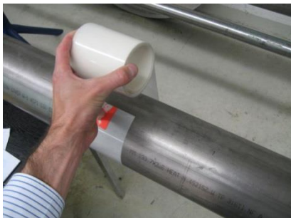
Abbildung 14: Anbringen der Kunststoffschablone 1
