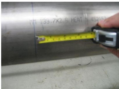
Abbildung 16: Ermitteln des Abstandes zur ersten Linie
