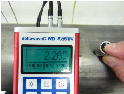
Abbildung 1 Wanddickenmessung mit deltawaveC-WD
