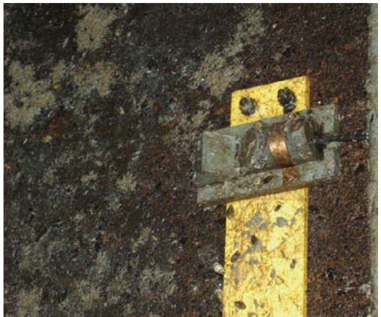
Ultraschallwandler nach zweijährigem, ununterbrochenem Betrieb
