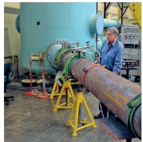
Abb. 7: Kalibrierung einer Dampfmesstrecke bei der PtB
