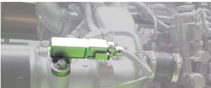
Truckflow Staudrucksonde für Luft vor Turbolader aus Kunststoff mit Einschnapp-dp-Messumformer
