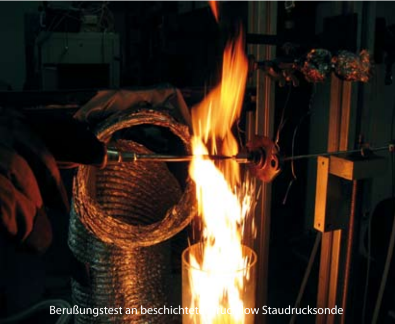
Hochtemperatur-Anti-Haftbeschichtung auf Edelstahl-Staudrucksonde
