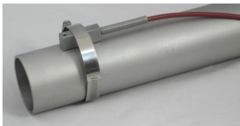
Abbildung 22: Pt100 auf Rohrleitung montiert
