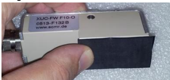
Abbildung 10: XUC-FW F10 mit akustischem Koppelpad
