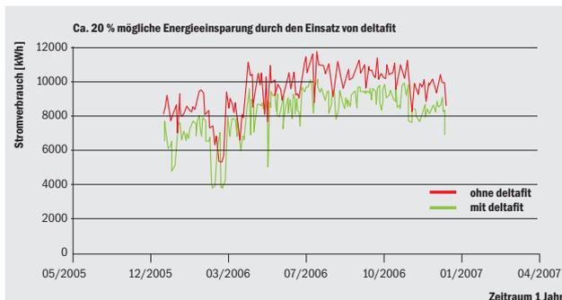
Typischer Energiebedarf einer mittelgroßen biologischen Abwasserreinigungsanlage
