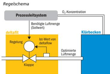
leitungen. Die Luftverteilung der Anlage ist dadurch ständig zum Teil starken Schwankungen ausgesetzt. Deshalb ist die Regelung der Luftzuführung nach der Sauerstoffkonzentration für eine verbrauchsoptimierte Regelung zu träge: Die O<sub>2</sub>-Konzentration reagiert erst mit Verzögerung auf die aktuell zugeführte Luftmenge. Dadurch schwankt die O<sub>2</sub>-Konzentration kontinuierlich um den Sollwert, was sich ungünstig auf den Energieverbrauch und den Reinigungsprozess auswirkt.
