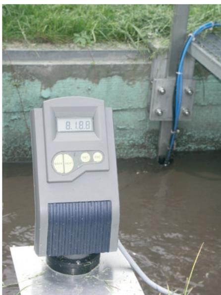
Im Vordergrund das Füllstandmesssystem zur Bestimmung der Pegelhöhe, diagonal dahinter (unter Wasser) die an einer Edelstahlschiene montierten Ultraschallsensoren zur Ermittlung der Durchflussmenge.
